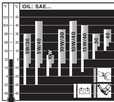
Wählen Sie die empfohlene Viskosität in Abhängigkeit von der Startart (Reversier-, Handkurbel- oder Elektrostart) und von der Umgebungstemperatur, bei welcher der Motor betrieben wird.
